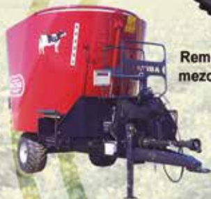
Remolque transportador de pienso a granel, tándem, opcionalmente equipamiento hidráulico
